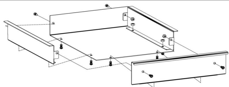
**Schritt 4 / Step 4 / Étape 4****Zusammenbau Grillrost**
