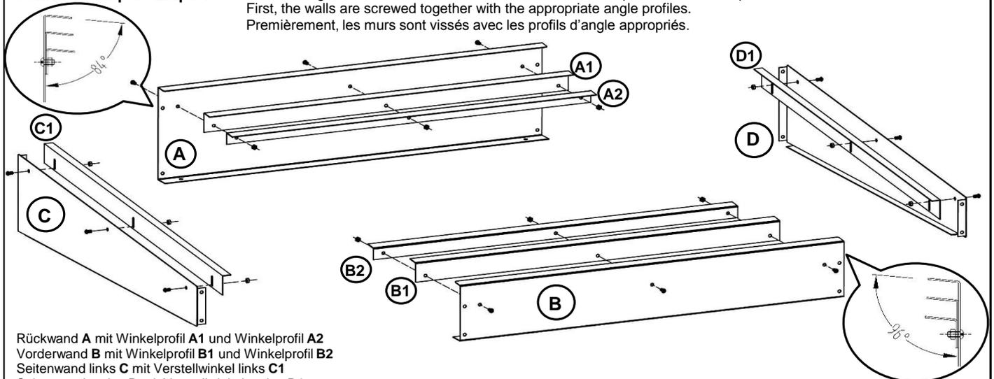
Rückwand **A** mit Winkelprofil **A1** und Winkelprofil **A2**
