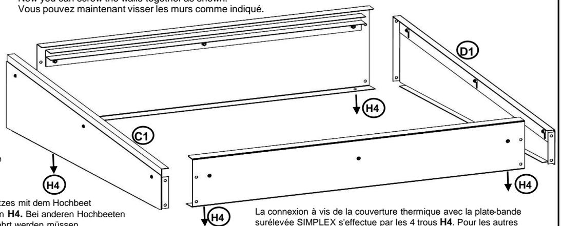
Die Verschraubung des Frühbeetaufsatzes mit dem Hochbeet **SIMPLEX** erfolgt durch die 4 Bohrungen **H4**. Bei anderen Hochbeeten könnte es sein, dass neue Löcher gebohrt werden müssen.
